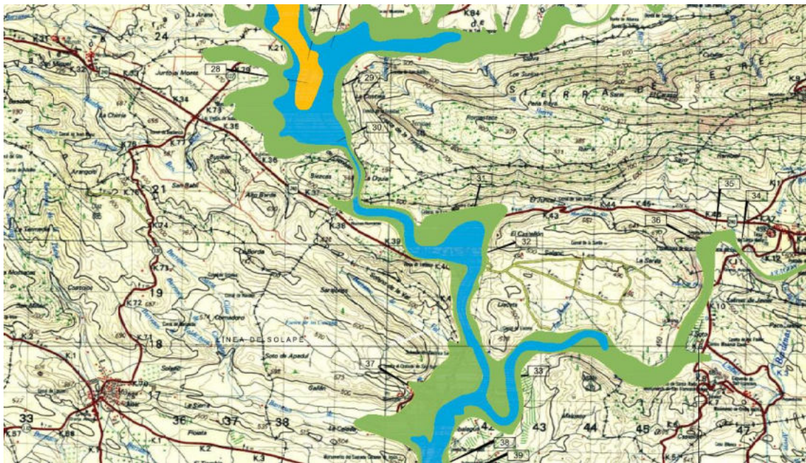
Figura 20. Zona inundable. Hipótesis de rotura PPH2. Amarillo: primeros 30'; Azul: primera hora; verde: segunda hora.
