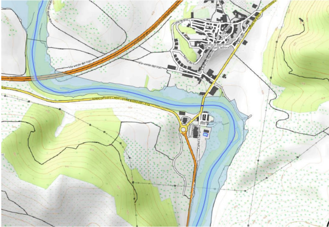
Figura 17. Desbordamientos a la altura del núcleo urbano (T100 años)
